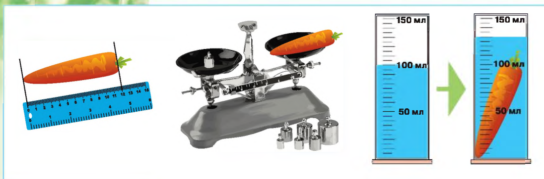
Рис. 10. Измерение размера, массы и объёма тела неправильной формы
